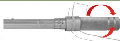
3. Заблокировать регулировочный механизм, нажав на фиксатор блокировки в направлении, показанном на рисунке.
